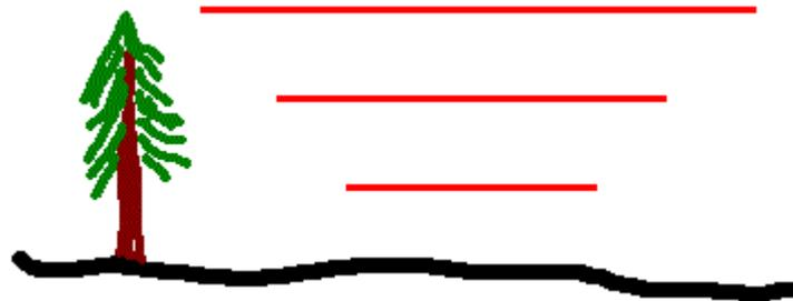
Bodenferne Antennen strahlen flach (Fernverkehr / DX),
